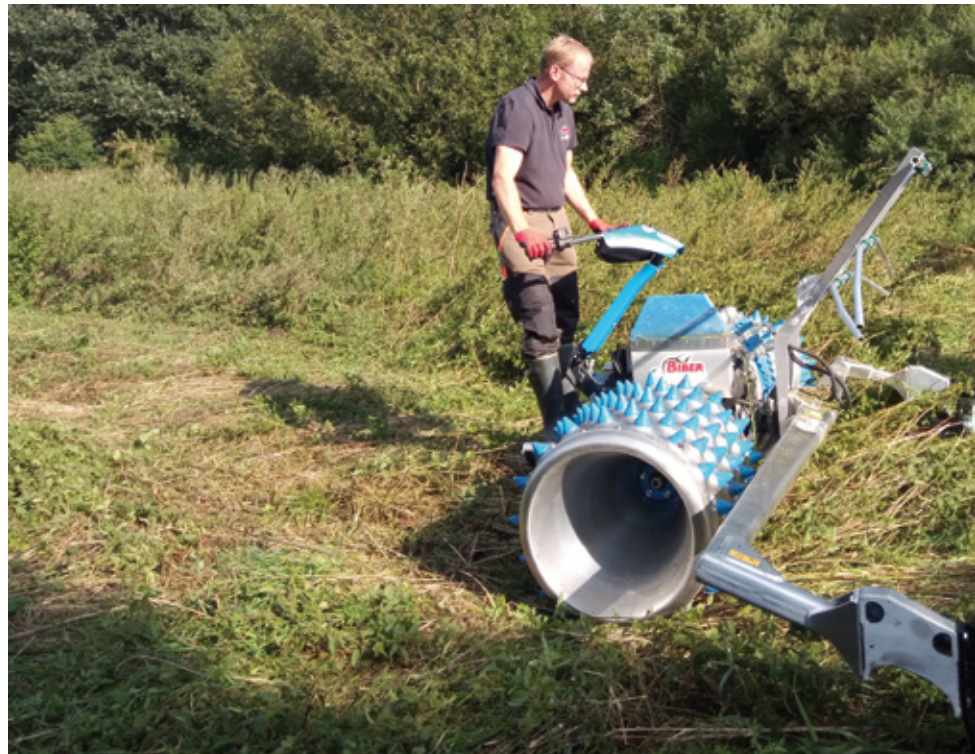
Stachelwalzenmäher im Einsatz bei der ÖNSOR
